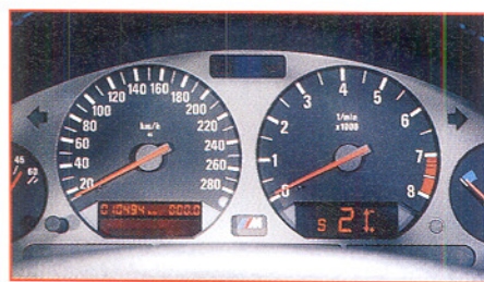
Bild 5: Wie in der Formel 1: Das Digitaldisplay im Drehzahlmesser zeigt den Schaltzustand an und gibt Schaltempfehlungen an den Fahrer. (Foto: BMW)
