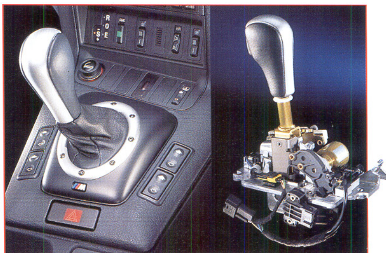
Bild 4: Der Schalthebel des sequentiellen M-Getriebes von BMW, rechts sind deutlich die Schaltelemente zu sehen. (Foto: BMW)
