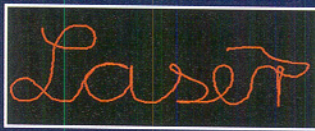
Bild 14: Figuren erzeugt mit der X-Y-Ablenkeinheit
