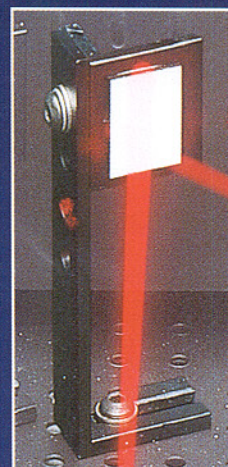
Bild 4: Spiegelhalter mit angeschraubtem Haltewinkel und aufgeklebtem Oberflächenspiegel
